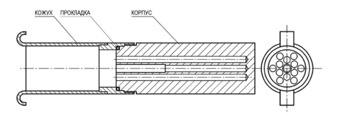
Защитный кожух служит для предотвращения нежелательного контакта эталонного термометра и термометров сопротивления с рабочей жидкостью термостата.
